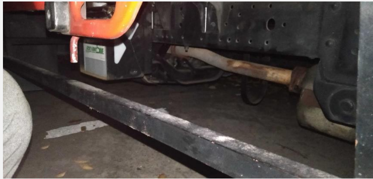
△マフラーの継ぎ手から漏れが…
